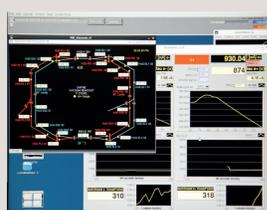
Un dettaglio dell'interfaccia degli strumenti diagnostici che consentono di controllare il vuoto all'interno dei tubi in alluminio in cui circolano i fasci
