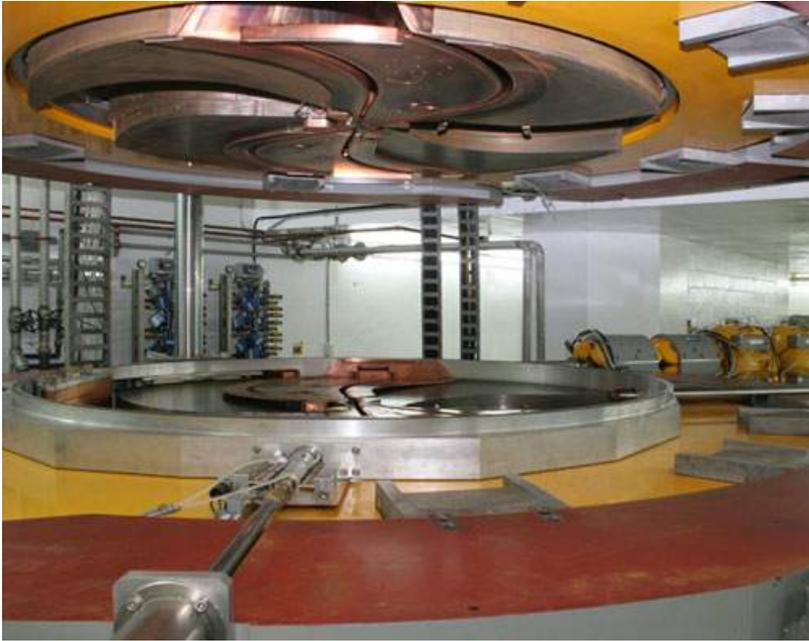
Il *ciclotrone* è stato progettato con l'intenzione di superare le limitazioni dell'acceleratore lineare. All'epoca (1930) non era possibile generare onde radio contemporaneamente ad alta frequenza ed alta potenza, per cui gli stadi di accelerazione lineare (DTL) dovevano essere spazati tra loro ed erano necessari più stadi (per compensare la limitata potenza). **Per ottenere energie elevate era necessario costruire acceleratori lunghi** e, oltre un certo limite, troppo costosi.
