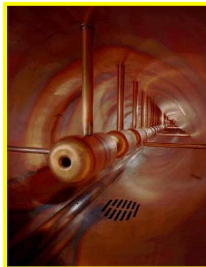
La **struttura di Alvarez** è basata su questo concetto ed è molto utilizzata nell'accelerazione di **protoni e ioni di bassa-media energia**. Essa può essere descritta come uno speciale DTL in cui gli elettrodi sono parte di una macrostruttura risonante.
