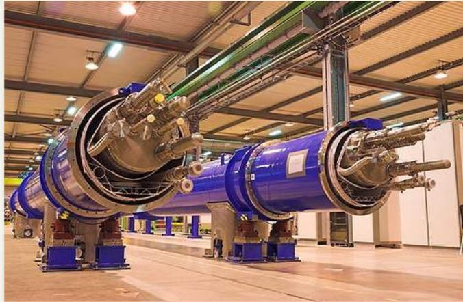
Con dipoli superconduttori si può pensare di arrivare a campi dell'ordine della 15-20 T (8 T LHC)
