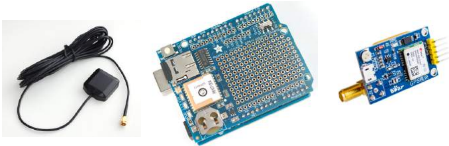
Low cost GPS module (<30 Euro) 25 ns precision
