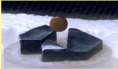
Levitazione magnetica di un magnetino (0.1 Tesla) su pezzi di YBCO materiale superconduttore ceramico. Foto LNF-INFN
