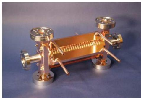
Strutture ad alto gradiente possono raggiungere  **$\sim 100-150$  MV/m** di campo accelerante con numero di scariche limitato.
