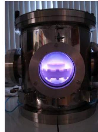
I **protoni** possono essere generati a partire da molecole di **idrogeno** che vengono portate allo stato di plasma da sorgenti a radiofrequenza
