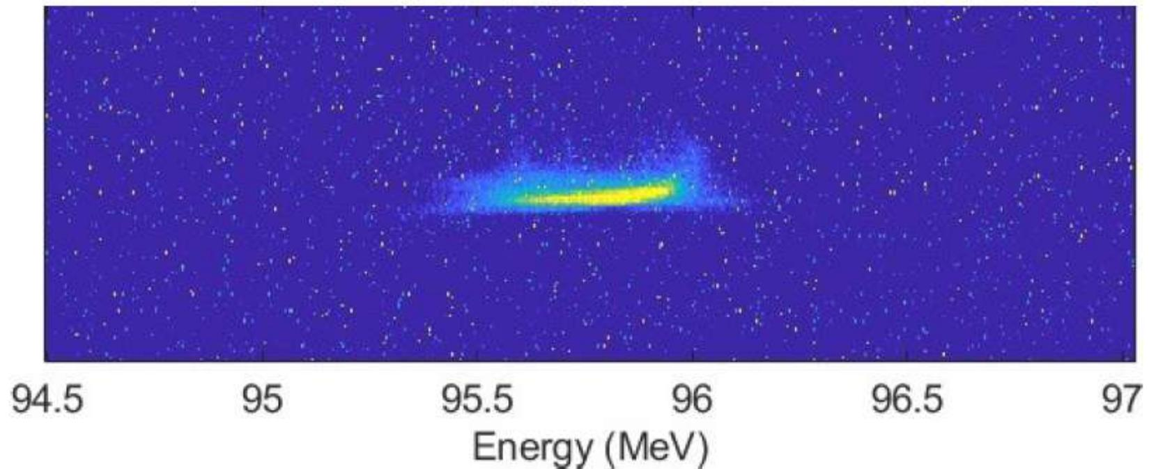
**Figura 2:** fascio witness accelerato a SPARC\_LAB. Immagine acquisita sulla targhetta a valle dello spettrometro magnetico. L'energia iniziale (senza plasma) è di 89.8 MeV. Accendendo il plasma, il witness guadagna 6 MeV lungo i 3 cm del capillare, arrivando a 95.8 MeV.
