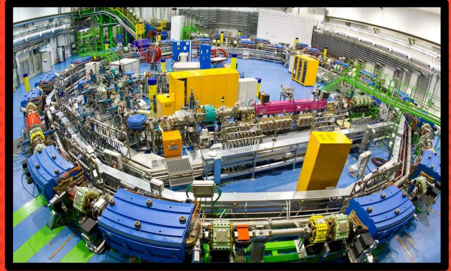
I fasci utilizzati in adroterapia devono essere accelerati fino ad ottenere l'energia voluta e per farlo vengono utilizzati acceleratori di particelle, molto simili a quelli sviluppati per le ricerche di fisica fondamentale.
